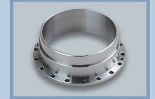
材質: S45C-(H) 真円度: 0.015 サイズ: Ø80×Ø60×t21薄肉部 t2
